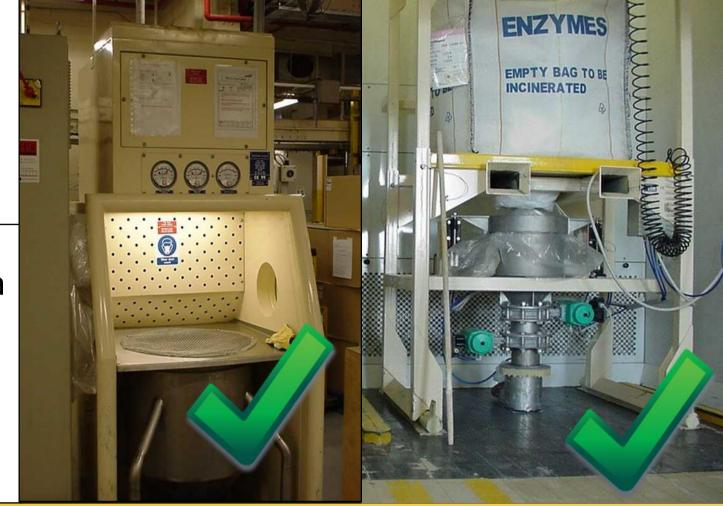
Quantità maggiori di enzimi [>1kg] devono essere scaricate, pesate e dosate utilizzando sistemi totalmente a contenimento totale [es. chiusi]; anche i processi successivi devono essere totalmente contenuti per evitare il rilascio di enzimi in polvere o aerosol.
