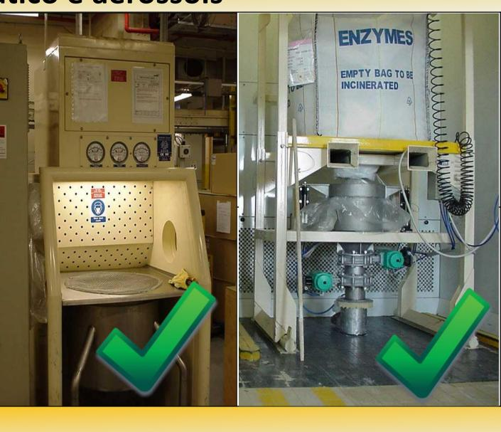
Quantidades maiores de enzimas [> 1 kg] devem ser descarregadas, pesadas e doseadas em sistema fechado; e qualquer processo a jusante deve ser também inteiramente contido (fechado) para impedir a libertação de poeiras ou aerossóis.
