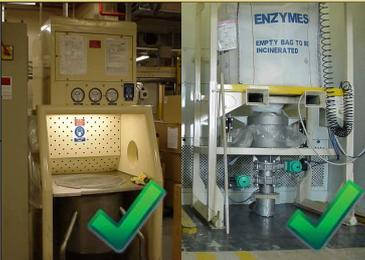
Größere Enzymmengen [ $> 1\text{ kg}$ ] müssen in einem vollständig eingehausten [d.h. geschlossenen] System geschüttet, gewogen und dosiert werden. Ebenso müssen alle Folgeprozesse vollständig eingehaust sein, um die Bildung von Stäuben oder Aerosolen zu vermeiden. Wenn sich Lücken oder Öffnungen in der Einhausung befinden, ist eine Lüftungsüberwachung notwendig, um einen in die Einhausung gerichteten Luftstrom sicherzustellen und die Freisetzung von Enzymstaub oder –aerosol zu verhindern.
